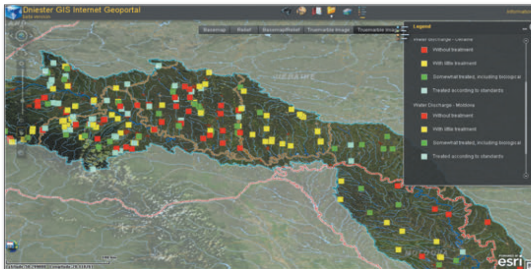
Рис. 4.10. Слои: сброс сточных вод и речная сеть бассейна/космический снимок_true/marble
