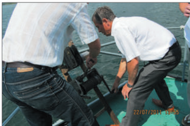
Рис. 2.5. Отбор проб донных отложений, Днестровское водохранилище, Новоднестровск, 675 км, Украина
