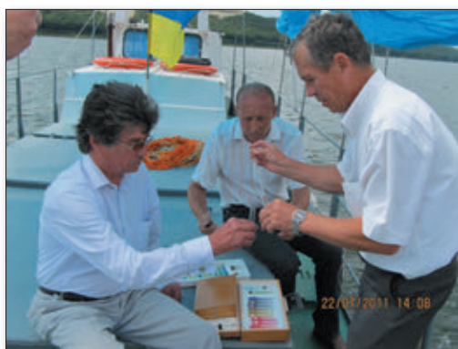
Рис. 2.17. Определение рН воды на борту экспедиционного катера, Днестровское водохранилище, Украина
