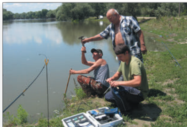
Рис. 2.6. Отбор проб донных отложений, рукав Турунчук, с. Троицкое, Украина
