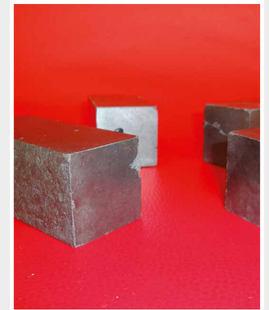
Produit final obtenu par la technologie de stabilisation et de solidification © Ministère de l'Agriculture, de l'Alimentation et de l'Environnement, Espagne
