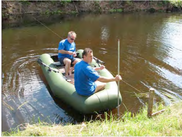
Рис. 8 – Измерения координат поперечного сечения в канале выше Выжевского водоспуска
